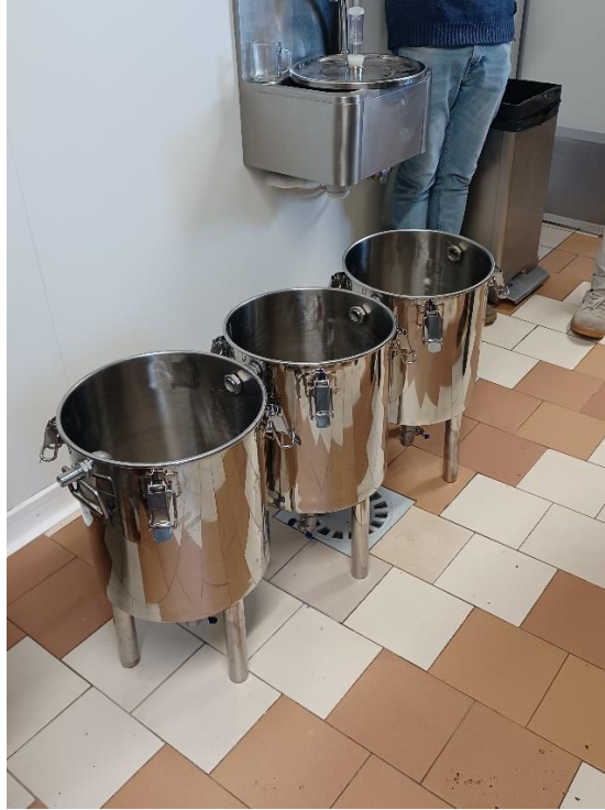
Système de décantation 3 x 30 L (source personnelle)
